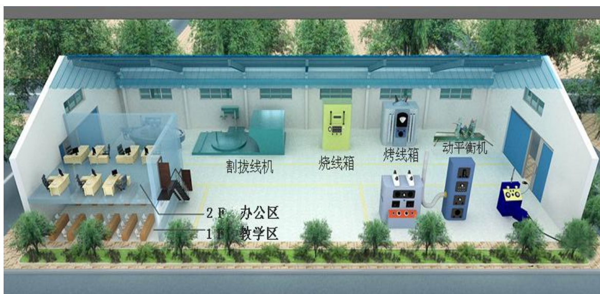
电机电器维修车间内部布局图
